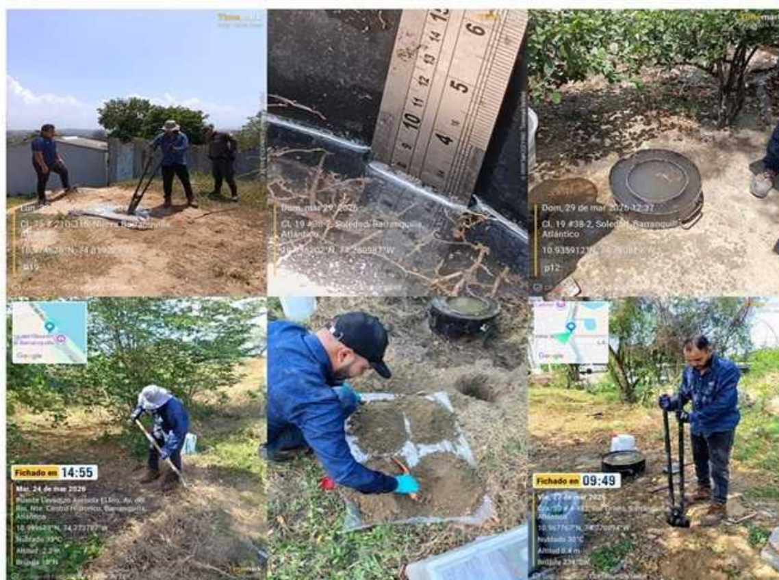
Foto 5. Toma de muestras y pruebas de infiltración en campo
